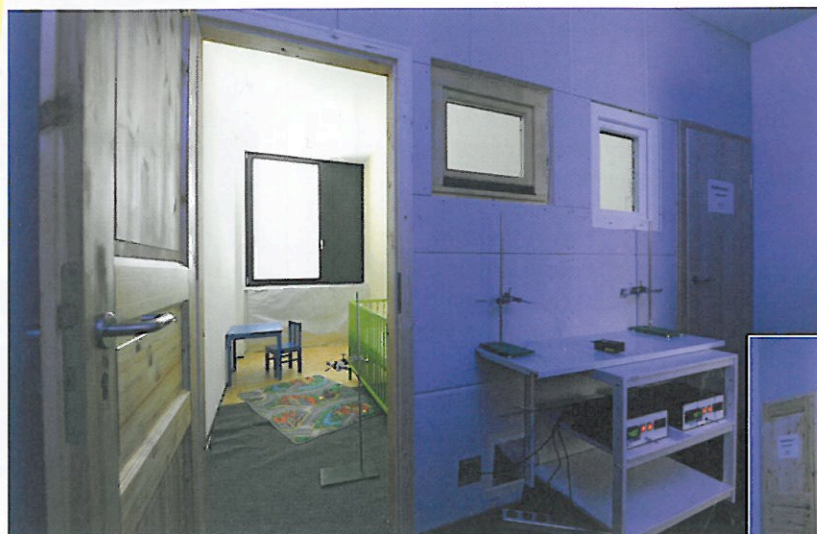
1 Kinderzimmer im Schadstofftest: Das eine wurde konventionell renoviert, das andere mit ausgewiesenen gesundheitsverträglichen Materialien, dazu zählen auch Fenster und Türen.
